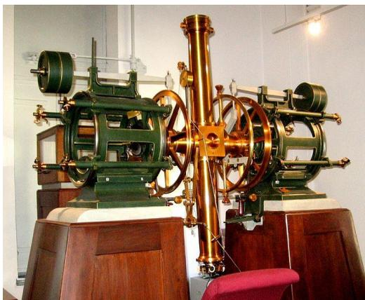
Bild 6. Passageinstrument (Quelle: H.Raab, Kuffner-Sternwarte, Wien)
