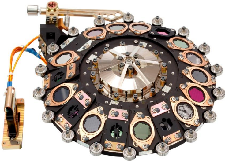
Die Mechanik für das Filtrerrad des MIRI-Instruments des James Webb Space Telescope wurde am MPIA entwickelt (Bild: MPIA)
