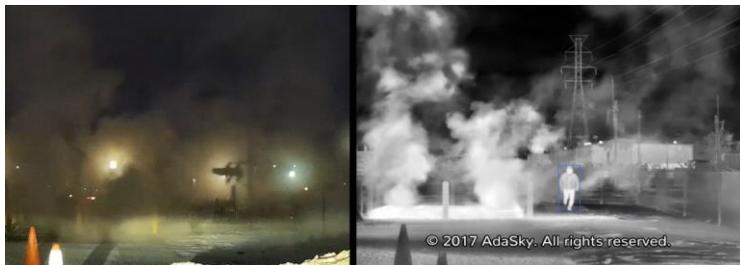
Bild 4b. FIR vs. CMOS Darstellung bei Dunst
