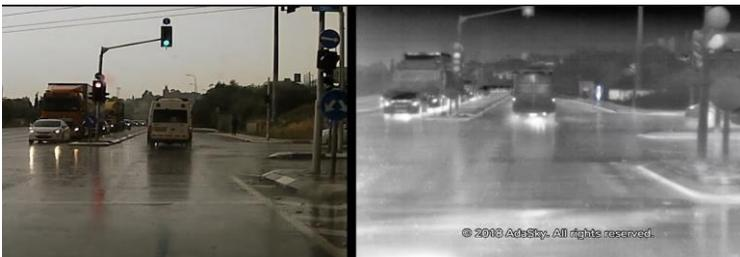
Bild 3. FIR vs. CMOS Darstellung bei Regen
