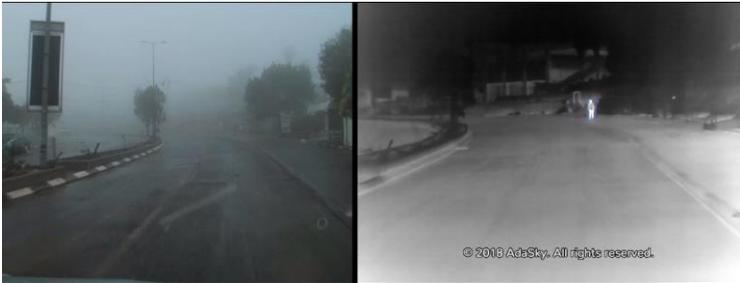
Bild 2. FIR vs. CMOS Darstellung bei Nebel
