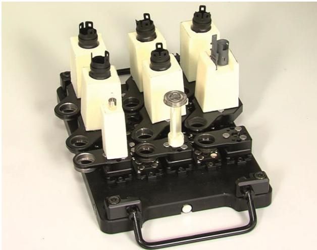
Bild 4. Für prozessintegrierte Messungen und 3-Schicht-Betrieb kann ein automatisches Werkstückwechselsystem innerhalb der Strahlenschutzhaube des CT-Geräts integriert werden
