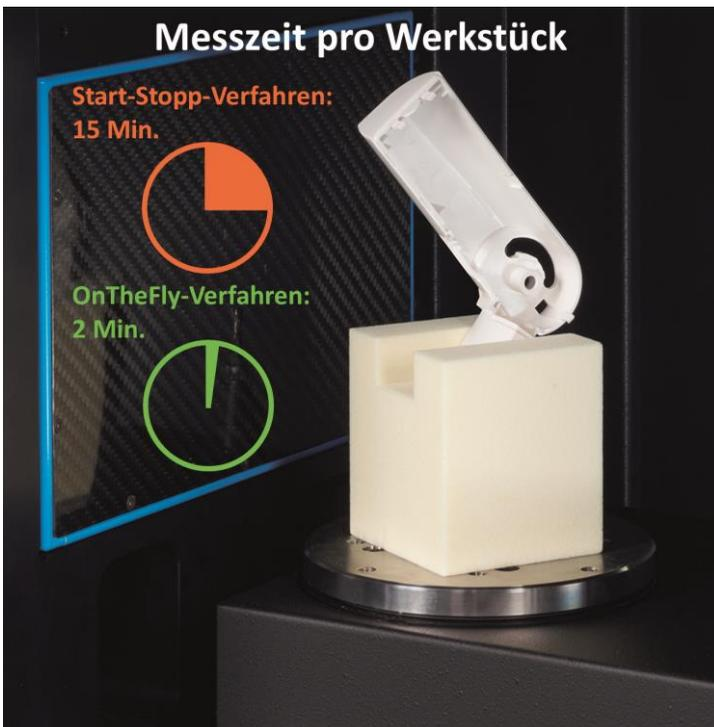
Bild 2. Die neue OnTheFly-CT ermöglicht fertigungsbegleitende Messungen mit hohem Durchsatz
