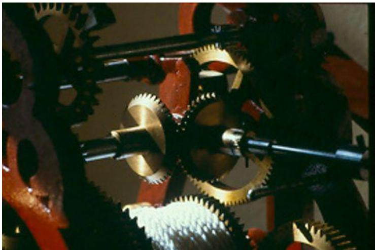
Bild 4. Kegelradgetriebe (Quelle: Uhrenmuseum Rockenhausen)
